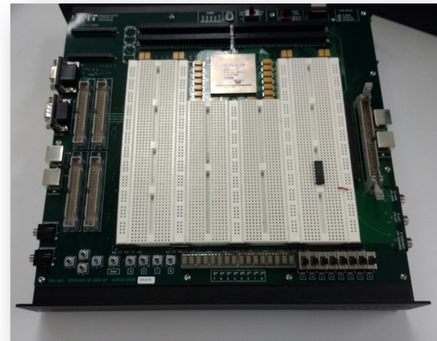
First FPGA Labkit at MIT ~2003
